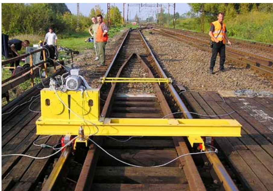
Zespół dr. J. Bienia przy pracy ze specjalistycznym wzbudnikiem drgań do badań dynamicznych mostów kolejowych
