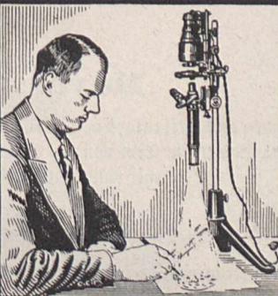
Promar im Aufbau als Mikroskop mit eingebautem Kreuztisch.
