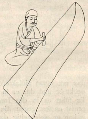
Herstellung einer zerlegbaren Thonform zum Guss eiserner Glocken.
