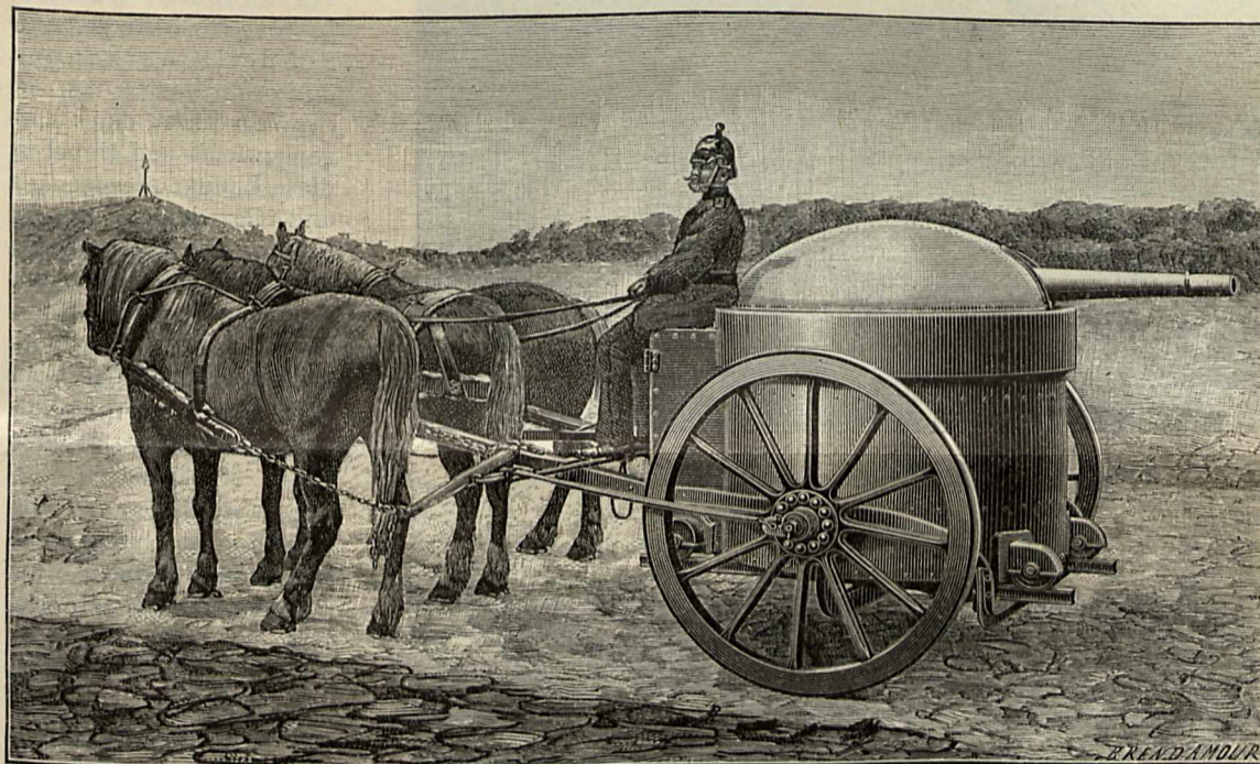
Fahrbare Panzerlaffete für eine 5,3 cm-Schnellfeuerkanone. Aufgeprotzt.
