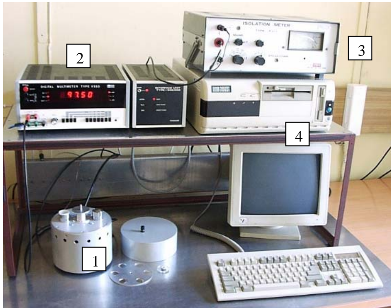
Rys. 8.11. Pełny układ do badania charakterystyk zaniku ładunku metodą wirującej próbki:
