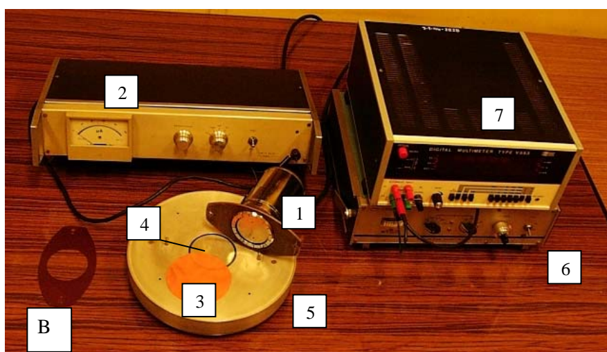
Rys. 5.5. Głowica wibracyjna (A) i pełny układ kompensacyjny (B) do pomiaru gęstości ładunku (objaśnienia w tekście)
