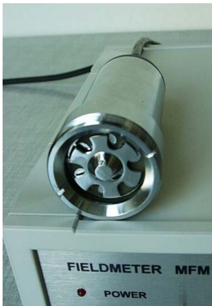
Rys. 5.7. Młynek polowy – głowica przyrządu do monitoringu pola (ładunku) MFM-200A. Widoczna obrotowa przesłona i elektrody przetwornika
