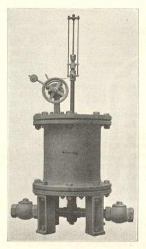
Fig. 22a. Automatische Kalkmischpumpe, Kokerei Fuchsgrube.
