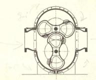
Fig. 21. Gassauger, Bauart Aerzen, Kokerei Fuchsgrube. 1:40.
