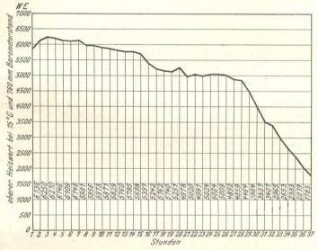
Fig. 32. Heizwertkurve des Destillationsgases während der Vergasung im Koppers'schen Koksofen, Bahnschacht. Ofentemperatur =  $1000^{\circ}$  C (Niederschlesische Bahnschachtkohle).
