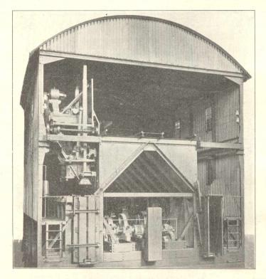
Fig. 13. Hartmannsche Beschick- und Auss oßmaschine, Kokerei Bahnschacht.
