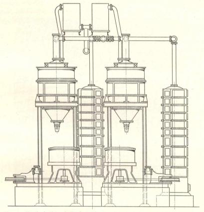
Fig. 23. Kontinuierlich arbeitende Sättigungsapparate, Kokerei Abendröthe. 1:100.
