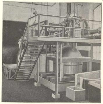
Fig. 24. Ununterbrochen arbeitender Sättigungsapparat, Ammoniakfabrik Fuchsgrube.
