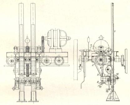
Fig. 12a. Stampfmaschine Bauart »Korotvicka«, Melchiorgrube. 1:40.
