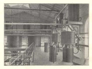
Fig. 29. Bedienungsbühne, Benzolfraktionsanlage Bahnschacht.
