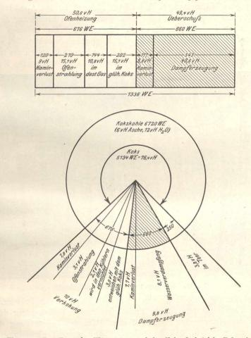
Fig. 30. Verteilung der Wärmemengen beim Koksofenbetrieb, Bahnschacht.
