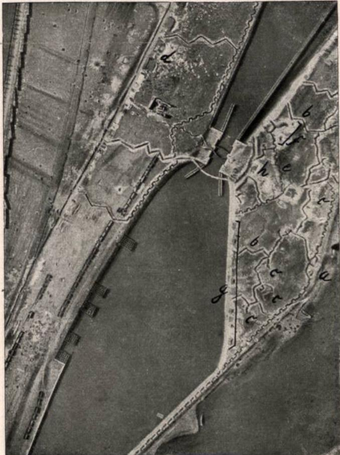
Abbildung 49c. Yserinsel nördlich Nieuport. f) und g) Minenwerferstände; h) Betonunterstand im Bau.
