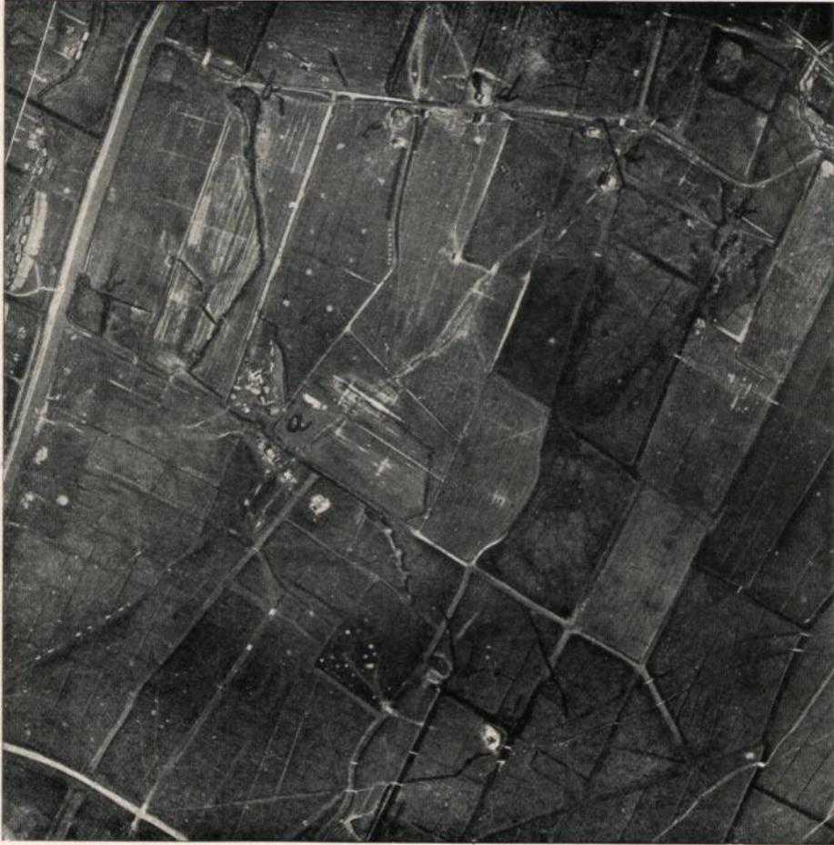
Abbildung 27. Gelände südwestlich Dixmuiden (Brennweite 70 cm, Höhe 3300 m). a) Feldkanonenstellung; b) Einzelne Stände für schwere Geschütze, weit auseinandergezogen; c) Scheinstellung; d) Stellungen im Bau; e) Infanterie-Reservestellung mit Betonunterständen.
