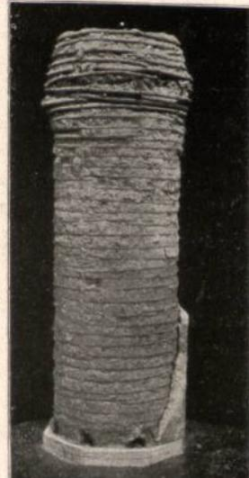
Abb. 20. Eisenumschnürte Betonsäule. (Aus Versuchen mit ringbewehrten Säulen der Firma Joh. Odorico, Dresden, und des Verfassers.)
