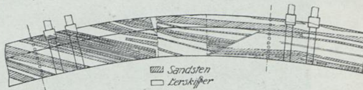
FIG. 5. BERGGRUNDEN UNDER MÖHNEDALDAMMEN.
