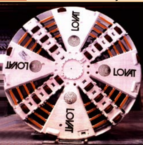
Z lewej: zmechanizowana tarcza EPB Lovat – Toronto z dyskami, umożliwiająca wyrównanie ciśnień w komorze roboczej
