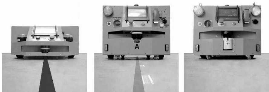
Rys. 3. Od lewej: robot posiadający czujnik pola magnetycznego, robot posiadający kamerę PGV, robot posiadający skaner laserowy [10]
