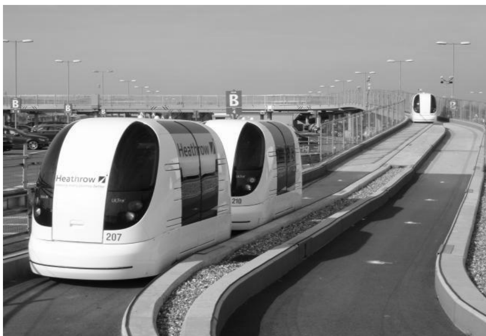
Rys. 1. Pojazdy autonomiczne ULTRA POD w porcie lotniczym London-Heathrow [6] Fig. 1. Automated vehicle ULTRA POD in London-Heathrow Airport [6]
