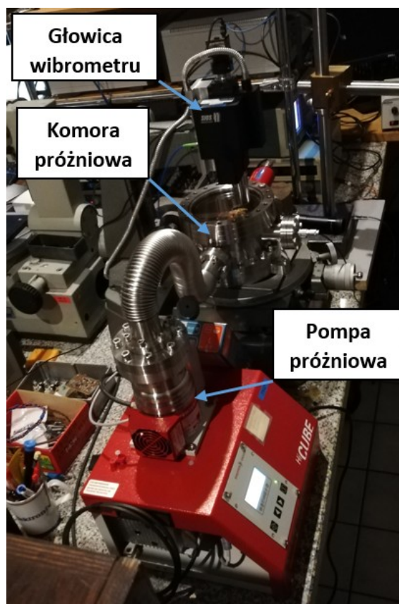
Rysunek 3.80: Układ pomiarowy do wyznaczenia częstotliwości rezonansowej GNEMS z zastosowanym wibrometrem laserowym [współpraca mgr inż. Piotr Kunicki].
