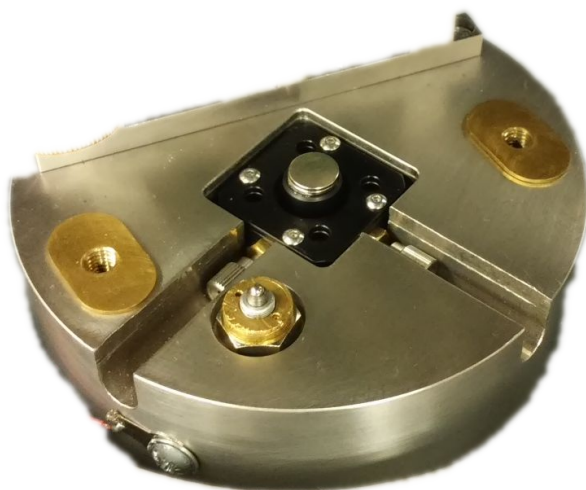
Rysunek 3.37: Układ pozycjonowania próbki bazujący na przesuwie optycznym firmy Thor-Labs [160] zamocowany w podstawie głowicy mikroskopu STM. Przedstawiona podstawa wykorzystywana była w trakcie pomiarów STM w trybie skanującego ostrza [współpraca dr inż. Paweł Zawierucha; opracowanie własne].
