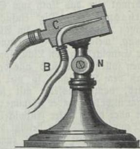
schlossen, die in der Mitte eine kreisrunde Oeffnung besitzt; das Rohr B tritt hinten in den Cylinder ein und mündet etwa 5 mm unterhalb dieser Oeffnung.
