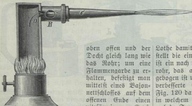
oben offen und der Docht gleich lang wie das Rohr; um eine Flammengarbe zu erhalten, befestigt man mittelst eines Bajonnettenschlosses auf dem offenen Ende einen pilzförmigen Kopf, dessen Oberfläche viele
