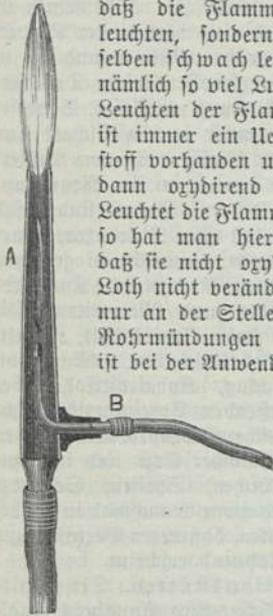
jede Explosionsgefahr ausgeschlossen. In der Mündung der beiden Rohre wird die höchste Temperatur entwickelt und müssen daher die Enden der Rohre aus Platin angefertigt werden.
