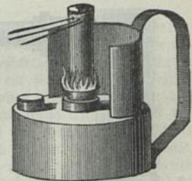
niederen, aus starkem Blech verfertigten Cylinder C besteht, welcher Weingeist enthält und in dessen Mitte sich ein festgelöthetes Rohr r befindet, das unten offen ist und circa  $\frac{1}{2}$  em vom Boden des Cylinders C absteht; in dieses Rohr ist ein zweites Rohr e eingepaßt, das mit einem gewöhnlichen Lampendochte überzogen ist, welcher letzterer oben über das Rohr hinausragt und auf dem Aufsatz des Cylinders
