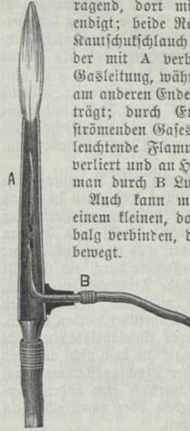
Auch kann man das Rohr B mit einem kleinen, doppelt wirkenden Blasbalg verbinden, den man mit dem Fuße bewegt.
