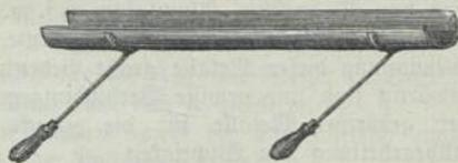
abgebildet ist. Die Retorten bestehen aus schmiedeeisernen Röhren (Fig. 91), welche 125 cm
