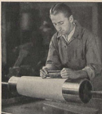
Abb. 66. Pigmentübertragung von Hand
