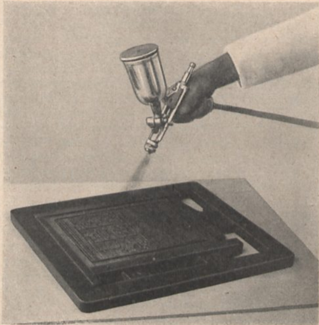
Abb. 29 Einspritzen des Satzes mit Texoprintlack
