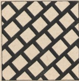
Abb. 62 Rasterstege beim Backsteinraster (Idealform)
