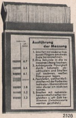
Abb. 87. Peha-Papier zur Bestimmung des Schwefelsäuregehalts in sauren Kupferbädern
