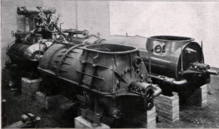
Abbildung 108. Parson-Turbinen des Torpedobootes „S. 125“, gebaut 1903/05 von der A.-G. Brown, Boveri & Co. in Baden (Schweiz).
