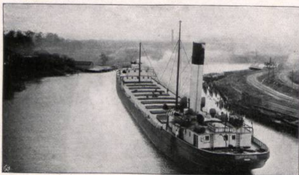
Abbildung 10. Amerikanischer Binnenseedampfer „Coralia“ der Pittsburgh Steamship Co. im Black River zwischen den großen Seen Nordamerikas. Die Frachtdampfer auf den großen Seen können infolge der gleichartig durchgeführten großartigen Landanlagen zum Übernehmen und Löschen der Ladung Winden und Masten ganz entbehren. Die beiden Pfahlmasten dienen nur Signalzwecken. L=126 m, B=14,6 m, Reg.To 4330 (3350). Gebaut 1896 bei Globe Iron Works Co., jetzt American Shipbuilding Co. in Cleveland (Ohio).
