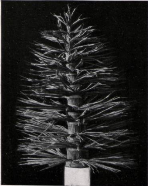
Abbildung 17. Fernsprechanchlusskabel mit Papierband- und Luftraumisolation, zur Abnahmemessung aufgeteilt (Kabelwerke Dr. Cassirer & Co., Charlottenburg).
