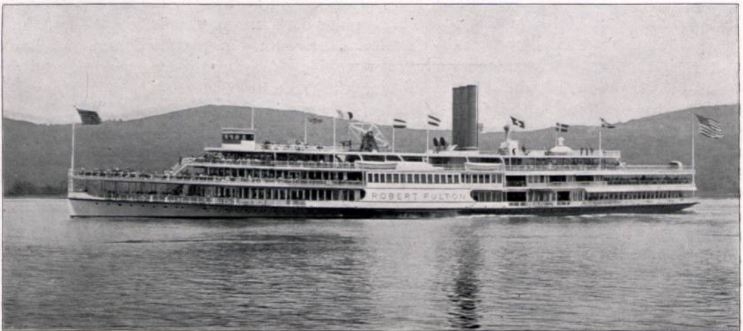
Abbildung 83. Dampfer „Robert Fulton“ der Hudson-River-Day-Line, gebaut 1909 von der New-York-Shipbuilding-Company. Größte Länge 106 m, größte Breite 23,2 m, Durchmesser der Seitenräder 9,4 m, maximale Geschwindigkeit 23 Knoten. Über dem obersten Deck, links von den Schornsteinen, ist der Balancier der Maschine zu sehen, der in größerem Maßstab in Abbildung 84 wiedergegeben ist.
