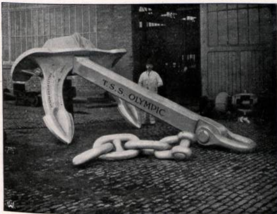
Abbildung 41. Anker und Kettenteil des Riesendampfers „Olympic“ (Schiffsabmessungen s. Abbildung 67).
