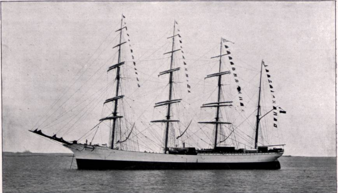
Abbildung 1. 1 Viermastbark „Herzogin Sophie Charlotte“, normaler großer Frachtsegler, gleichzeitig Schulschiff des Norddeutschen Lloyd. L = 84,22 m, B = 13,15 m, H = 7,75 m, Reg.To = 2591 (2248). Tragfähigkeit = 3400 t. Gebaut 1894 bei Rickmers Reismühlen, Reederei und Schiffbau A.-G. Bremerhaven.
