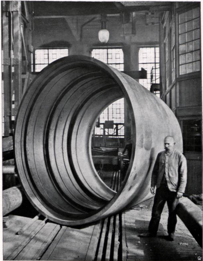
Abbildung 132. Turbinentrommel, geschmiedet von Fried. Krupp, Essen. Durchmesser vorn 3335 mm, Durchmesser hinten 2275 mm, Länge 2700 mm, Schmiegegewicht 53 t.
