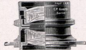
Abbildung 4a. Durchschnitt durch ein modernes photographisches Objektiv (Doppelmanastigmat von C. P. Goerz, Berlin).
