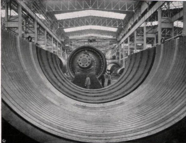
Abbildung 111. Gehäuseunterteil der Niederdruck-Vorwärtsturbine des Hamburger Dampfers „Imperator“, gebaut 1912 von den Vulcanwerken, Hamburg.
