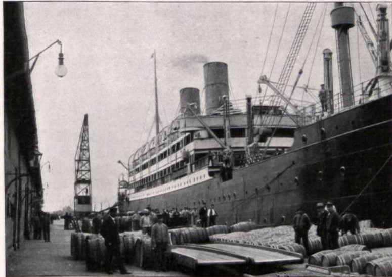
Abbildung 18. Großer Passagier- u. Frachtdampfer „Prinzess Irene“ des Nordd. Lloyd, Ladung nehmend mit hydraul. Kranen. L = 159,56 m, B = 18,34 m, H = 10,58 m, Reg. To = 10881 (8511), ind. P.S. = 8000, Geschw. = 15,5 Kn. Gebaut 1900 auf den Vulcanwerken, Stettin.
