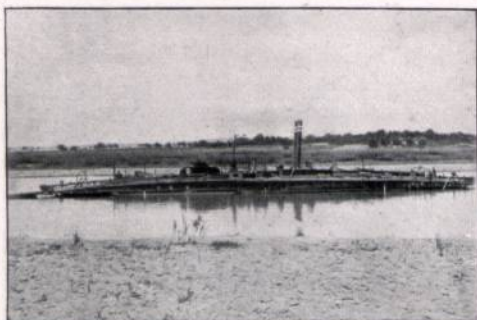
Abbildung 38. Kettenschleppdampfer „Baensch“ zur Fahrt auf der Elbe zwischen Magdeburg und Bodenbach. Zur Bergfahrt dient die im Strombett liegende Kette, die über den Dampfer geführt und auf diesem um ein Kettengreifrad geschlungen ist. Zur Talfahrt dienen zwei Turbinenpropeller. L = 52,42 m, B = 8,2 m, H = 2,36 m, Tiefgang 0,7 m, ind. P. S. der Kettenradmaschine = 180; ind. P. S. der Turbinenpropellermaschinen zusammen = 240. Gebaut 1896 von der Dresdener Maschinenfabrik und Schiffswerft Uebigau A.-G.
