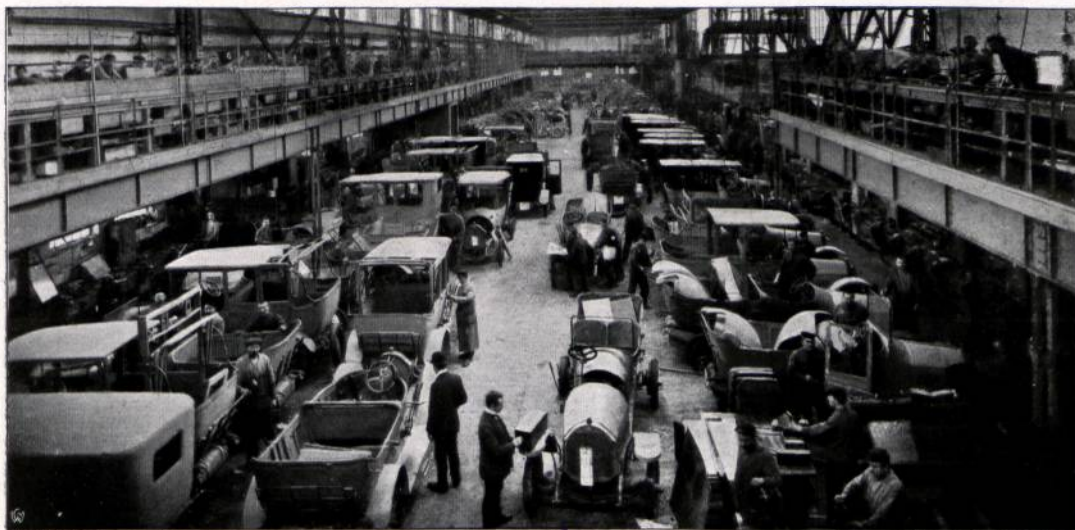
Abbildung 22. Benzwerke Mannheim: Wagenbau. Zusammenbau der Wagen und Karosserien.
