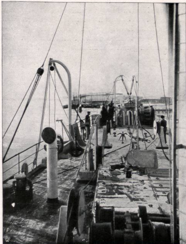
Abbild. 33. Vorderdeck eines Kabeldampfers mit großer Bugrolle und kleinen Leitrollen auf Deck; auf Deck liegen und hängen eine Reihe von Ankern und Geräten, die beim Kabellegen und -suchen gebraucht werden.
