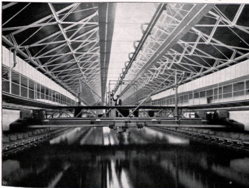
Abbildung 52. Schleppversuchsanstalt: über dem Bassin läuft der elektrisch betriebene Wagen, unter dem das Modell in der richtigen Schwimmlage geschleppt wird (Versuchsanstalt in Washington).
