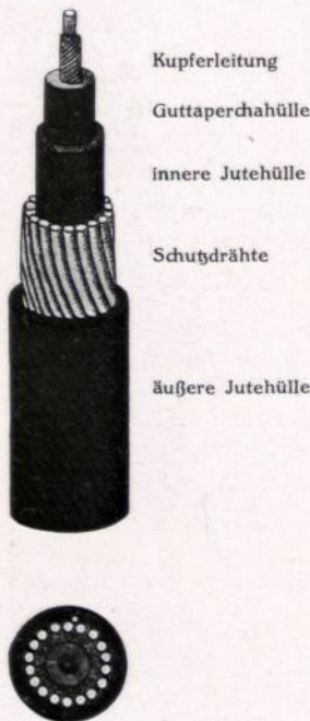
Abbildung 10. Zweites deutsch-atlantisches Kabel, Tiefseekabel (hergestellt und verlegt 1904 von den Norddeutschen Seekabelwerken Nordenham).
