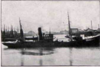
Abbildung 29. Hochsee-Fischdampfer 1 „Neckar“ der Deutschen Dampfschifferei-Gesellschaft „Nordsee“ in Nordenham, im Hafen von Nordenham. L = 39,61 m, B = 7,05, H = 3,41 m, Reg.To = 274 (74), ind. P. S. = 420, Geschw. = etwa 10 Kn. Gebaut 1907 bei J. Frerichs & Co. in Einswarden a. d. Weser.
