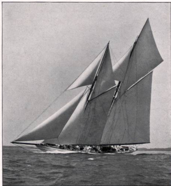
Abbildung 5. Schoneryacht „Germania“, die erste große in Deutschland entworfene und gebaute Rennschoneryacht. Entworfen von Max Oertz-Hamburg, gebaut bei Fr. Krupp A.-G. Germaniawerft, Kiel. L = 32,94 m (47,21 m), B = 8,16 m, Tiefgang = 5,41 m, Depl. = 250 cbm.
