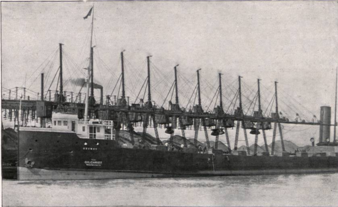
Abbildung 12. Amerikanischer Binnenseedampfer „Uranus“ beim Löschen der Ladung mit Greifern. L=105,5 m, B=14,6 m, Reg.To 3748 (2943). Ind. P.S. = 2000. Gebaut 1901 von der Detroit. Shipbuild. Co., Wyandotte.
