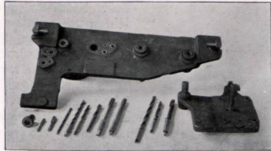
Abbildung 71. Einspannvorrichtung zur dritten Bohr- operation der Räderplatte Abbildung 68.
