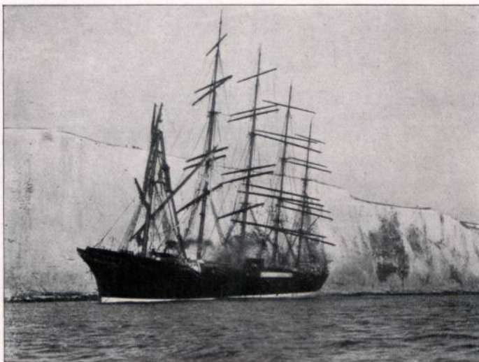
Abbildung 4. Fünfmastvollschiff „Preußen“ von Ferd. Laeisz-Hamburg, nach der Strandung bei Dover (November 1910). L = 124 m, B = 16,3 m, H = 9,96 m, Reg. To 50,81 (4765), Tragfähigkeit = 8000 t. Gebaut 1902 bei Joh. C. Tecklenborg A.-G., Geestemünde. Größtes bisher gebautes Rahsegelschiff.
