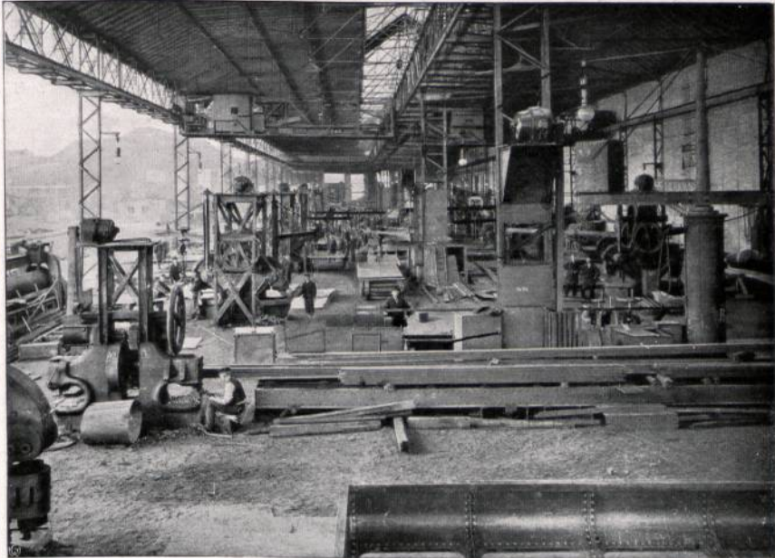
Abbildung 58. Schiffbauhalle der Flensburger Schiffbau-Gesellschaft in Flensburg. Die Abbildung zeigt die Bearbeitungsmaschinen für Platten und Winkel (Scheren und Lochstanzen) und die Deckenkrane zum Transport der Bauteile.
