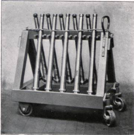
Abbildung 6. Spezialwagen, der die Beschädigung der Teile beim Transport verhindert.
