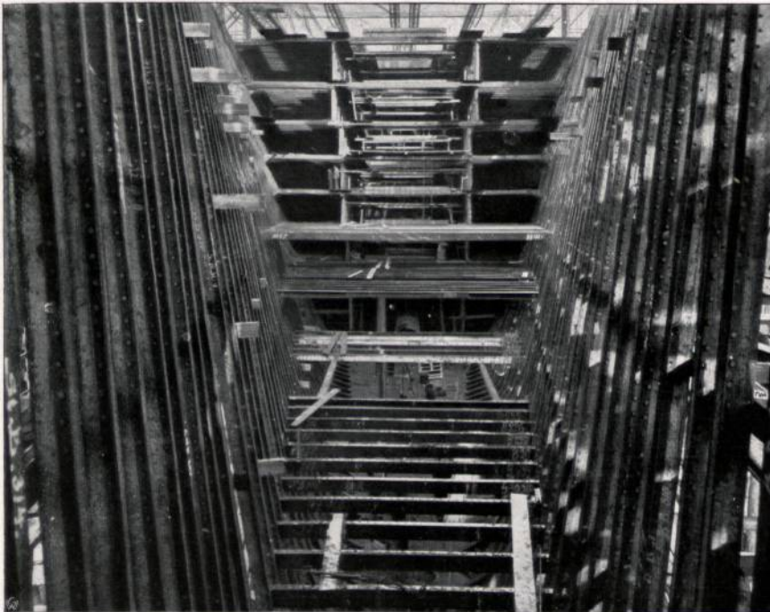
Abbildung 66. Blick in das Vorschiff des Riesendampfers „Imperator“ der Hamburg-Amerika-Linie während des Baues (Vulcanwerke in Hamburg). Mehrere Decksbalkenlagen übereinander, rechts und links die Spanten.
