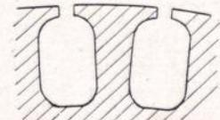
Abbildung 39. Halbgeschlossene Nuten.
