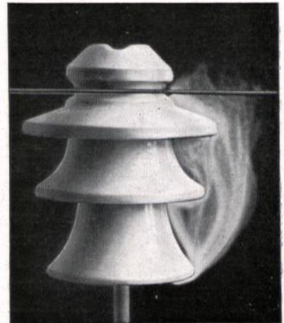
Abbildung 193. Derselbe Isolator wie Abbildung 192, aber naß geprüft.
