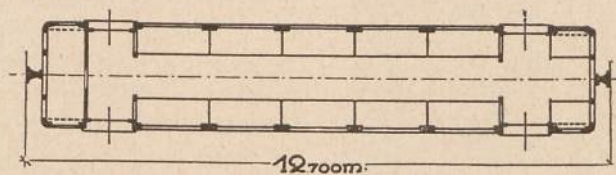
1. Wagen der Hoch- und Untergrundbahn mit Längssitzen und je einer Schiebetür am Wagenende
