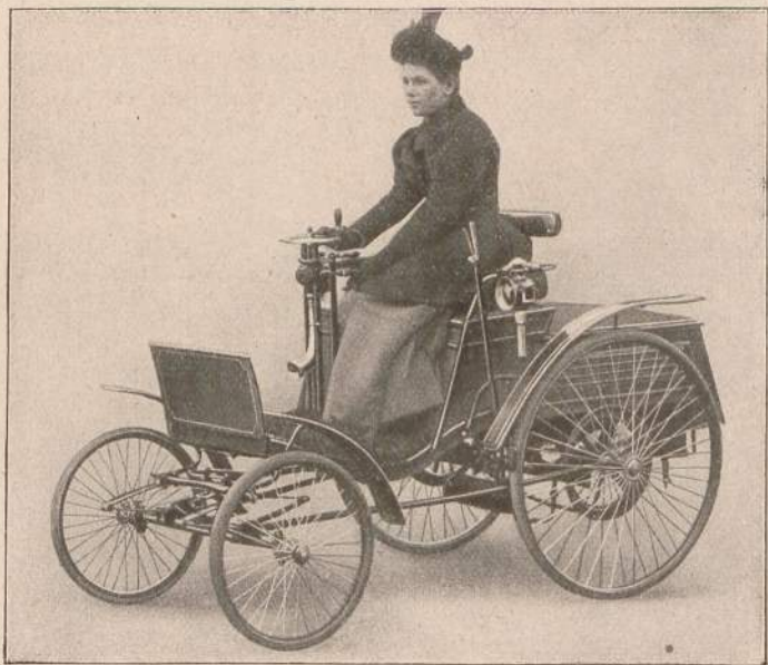
125. Der älteste Klein-Kraftwagen aus der Fabrik von Benz. Der Motor leistete 1\frac{1}{2} Pferdestärken
