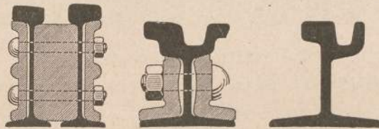
728. Querschnitte stählerner Rillenschienen
