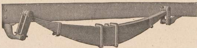
175. Tragfeder An Pendeln aufgehängt
