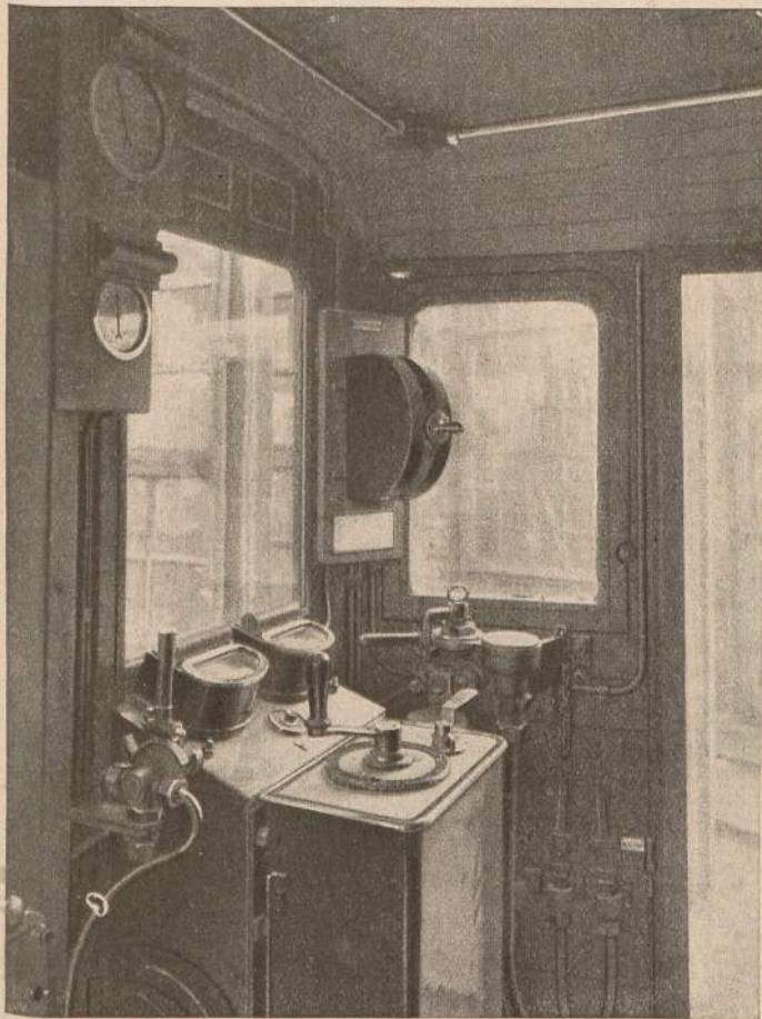
529. Fahrerstand einer elektrischen Schnellzug-Lokomotive Bauart der Siemens-Schuckert-Werke
