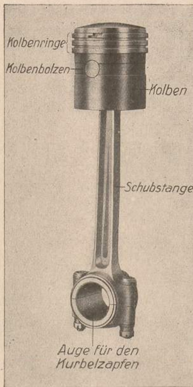
134. Kolben und Schubstange
