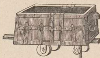
311. Das älteste Schienenfahrzeug: Förderhund und Spurnagel
