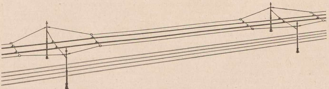
713. Aufhängung der Oberleitung über der Straße Unter den Linden Wegen des sehr weiten Abstands der Tragmasse mußten Hilfsstragdrähte ausgelegt werden
