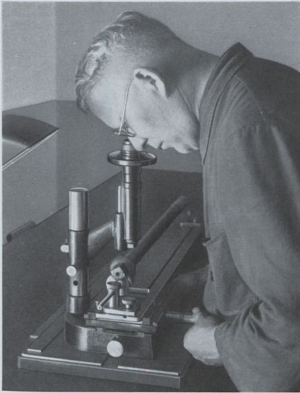
Steigung- und Flankenwinkelprüfung mit Werkstatt-Meßmikroskop.
