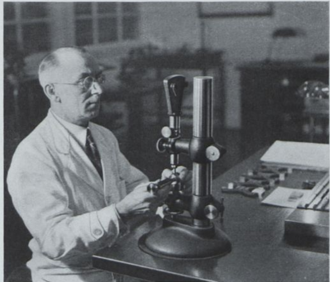
Prüfung von Grenzlehrdornen, Meßscheiben usw. auf Maßhaltigkeit, Unrundheit, Konizität usw. mittels Hirth-Minimeter oder Mikrotast.
