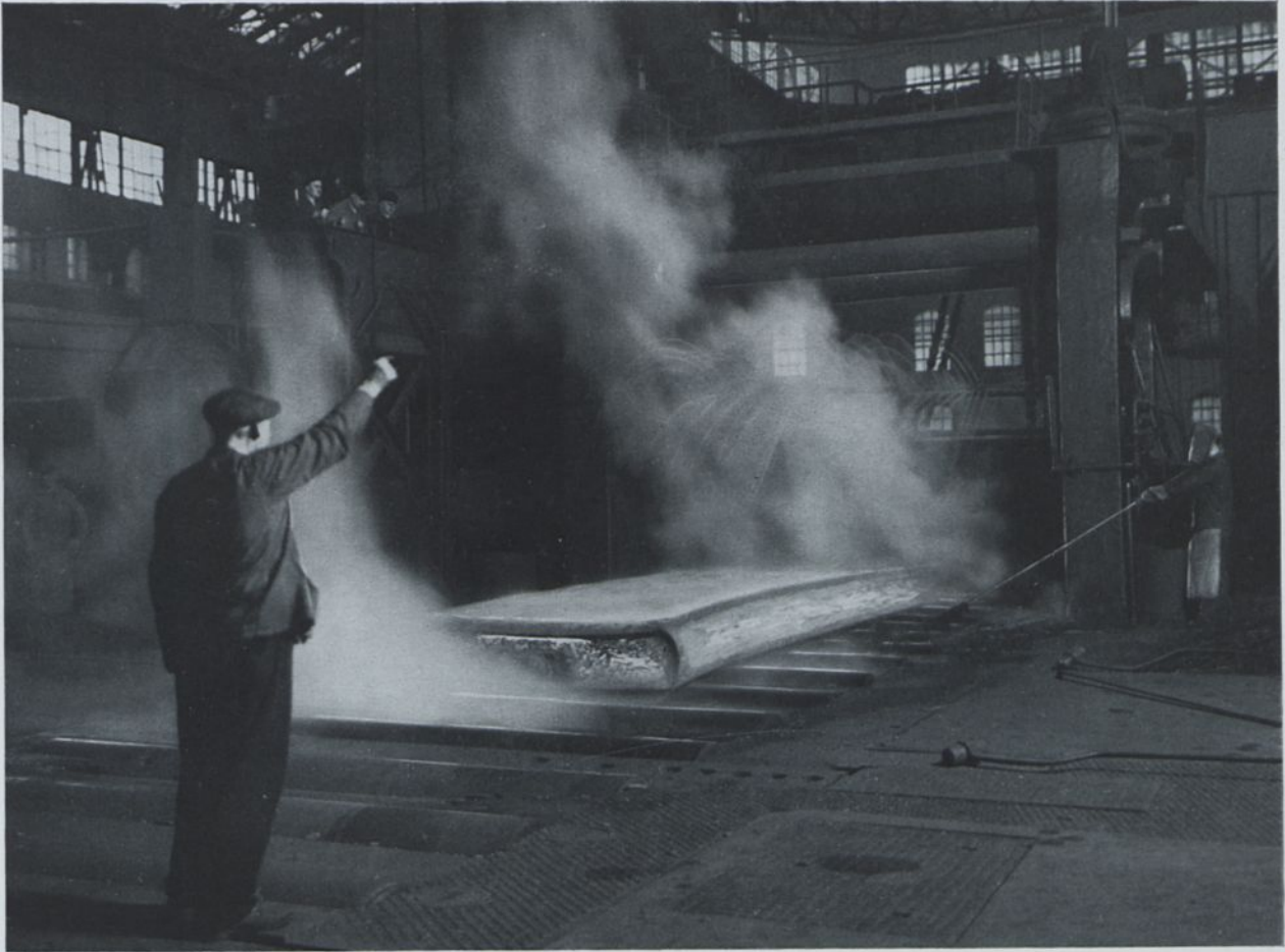
Blechwalzwerk. Auswalzen einer Bramme.
