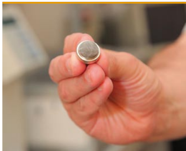
Czujnik w iskrobezpiecznej obudowie
