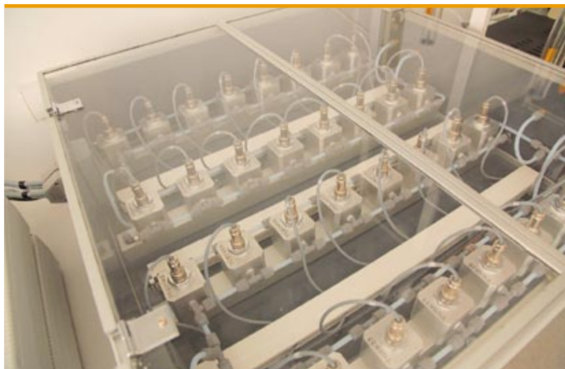
Matryca sensorów jako element czujnikowego systemu do badania mieszanin gazów
