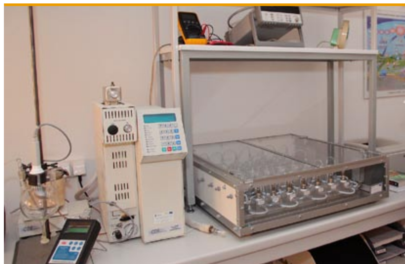
Czujnikowy system do badania mieszanin gazów z układem do przygotowywania prób gazów
