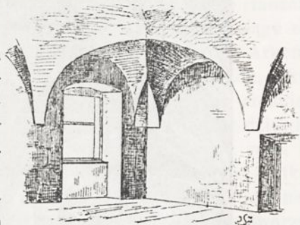
Rys: 118. Widok sklepienia Zygmuntońskiego z domu l. 9 ul. Szeroka w Krakowie na Kaźmirzu (do rys. 117.)
