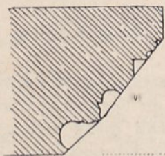
Fig. 3. Ciężkowice. Kościół parafialny. Okrój węgaru wejścia głównego.
