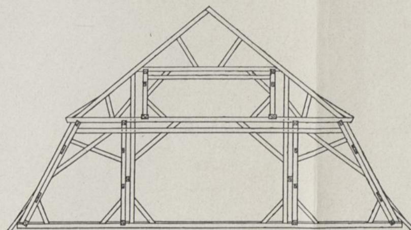
Querschnitt durch den Dachstuhl
