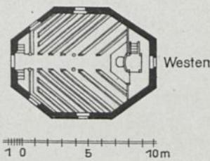
Abb. 84. Göhren. Grundriss der Begräbniskapelle.
