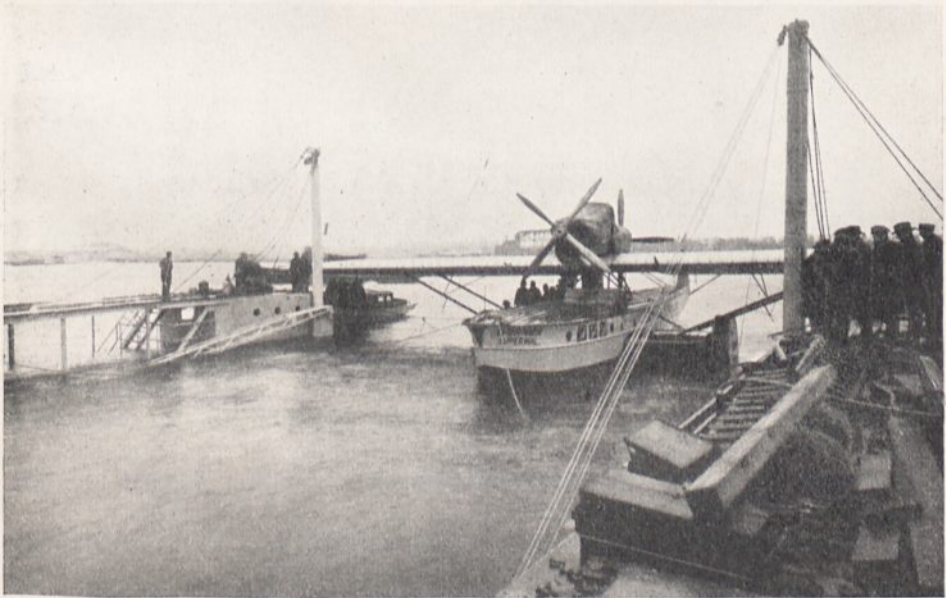
Abb. 17. Flugzeug beim Eindocken in das versenkte Dock.
