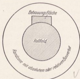
Abb. 1. Flächenverteilung eines Flughafens.
