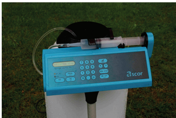
Rys. 3.8. Pompa infuzyjna AP 12 dozująca wodę do elektronicznego deszczomierza wagowego
