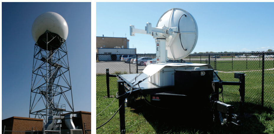
Rys. 3.15. Przykłady radarów pogodowych pracujących w paśmie C (z lewej) oraz w paśmie X (z prawej)
