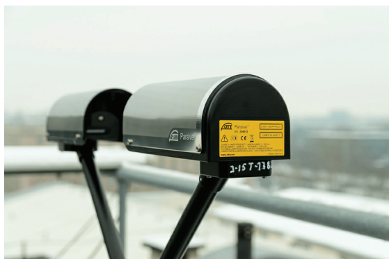
Rys. 3.11. Zainstalowany w Warszawie disdrometr laserowy Parsivel 2 firmy OTT
