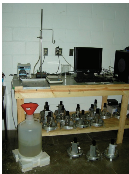
Rys. 3.5. Zestaw pomiarowy używany do testowania deszczomierzy korytkowych w laboratorium IIHR – Hydroscience & Engineering, Iowa State University
