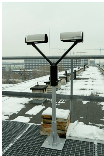
Rys. 3.11. Zainstalowany w Warszawie disdrometr laserowy Parsivel 2 firmy OTT
