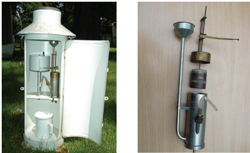
Rys. 3.1. Otwarta obudowa pluwiografu pływakowego z widocznym paskiem rejestracyjnym założonym na obracającym się bębnie poruszającym za pomocą mechanizmu zegarowego; po prawej stronie w powiększeniu zbiornik wewnętrzny na wodę z pływakiem i zamocowanym do niego ramieniem piórka, widoczna wygięta szklana rurka pełni rolę lewara opróżniającego zbiornik wewnętrzny (Licznar i in. 2005a)
