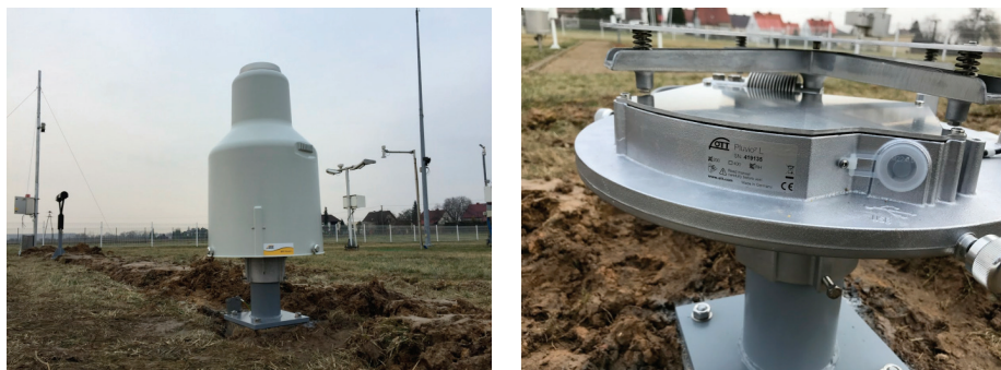
Rys. 3.6. Elektroniczny deszczomierz wagowy i jego mechanizm wagowy (przykład deszczomierza Pluvio 2 firmy OTT)
