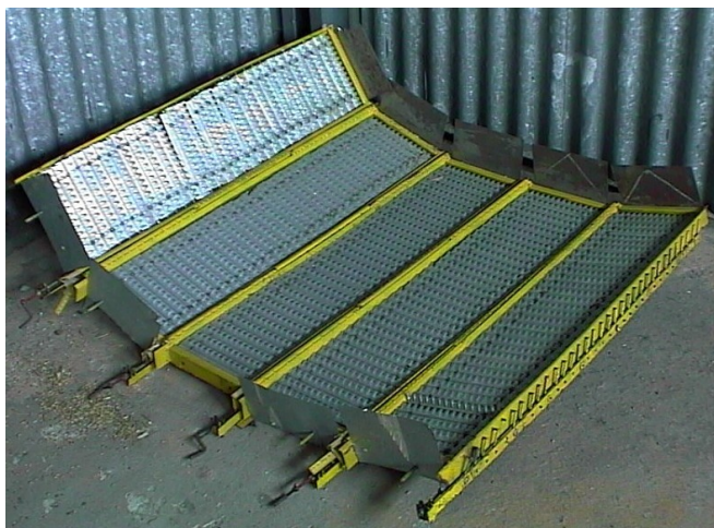
Fot. 1. Widok żaluzjowego sita cylindrycznego pięciosekccyjnego [fot. J. Bieniek]
