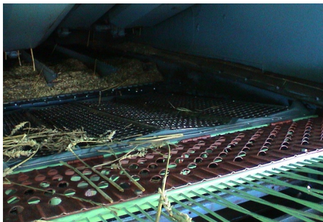
Fot. 6. Widok sita daszkowego zamontowanego w kombajnie Bizon Z 058 [fot. J. Bieniek] Phot. 6. View of the canopy sieve install in combine-harvester Bizon Z 058
