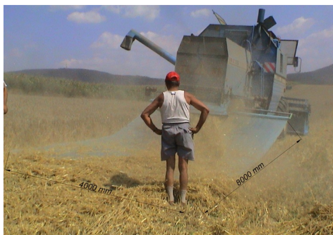
Fot. 7. Sposób zbierania ziarna w celu określenia strat [fot. J. Bieniek] Phot. 7. Drawing of samples to determine the loss of grain
