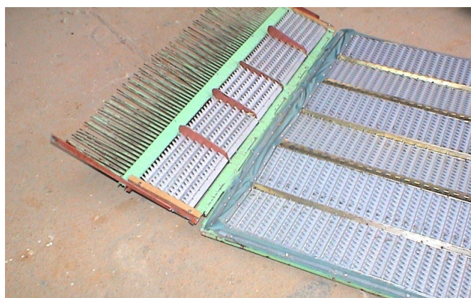
Fot. 5. Widok prototypu sita dwupłaszczyznowego do kombajnu zbożowego [fot. J. Bieniek] Phot. 5. View of the prototype two-plans sieve to combine-harvester
