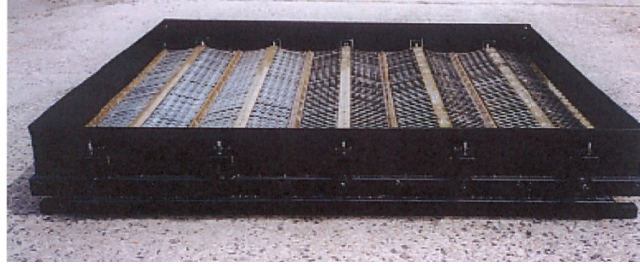
Fot. 2. Widok żaluzjowego pięciosekccyjnego sita daszkowego [fot. J. Bieniek] Phot. 2. View of the shutter canopy sieve with five section
