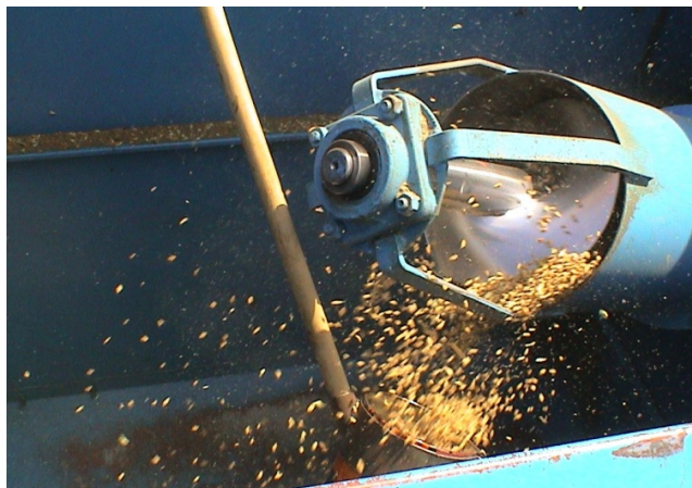
Fot. 8. Sposób pobierania próbek ziarna w celu określenia jego czystości [fot. J. Bieniek] Phot. 8. Drawing of samples to determine the clean of grain
