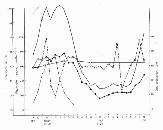
Rys. 3. Dopływ promieniowania i zmiany temperatury dla reaktora metanowego ogrzewanego energią słoneczną
