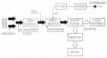
Fig. 1. Layout of batch experiment procedures Rys. 1. Schemat układu laboratoryjnego
