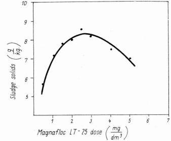
Fig. 5. Effect of Magnafloc LT-25 on thickening of sludge from Warsaw waterworks Rys. 5. Wpływ Magnafloku LT-25 na efekty sedymentacji i zagęszczania osadów z warszawskich pulsatorów
