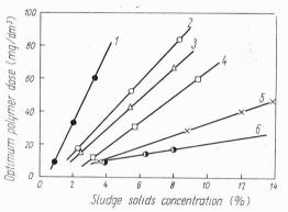
Fig. 11. Effects of initial solids and cake solids contents on optimum polymer dose, for cake solids: I - 22% d.w., 2 - 27%, 3 - 32%, 4 - 40%, 5 - 48%, 6 - 57%Rys. 11. Wpływ uwodnienia osadu odwadnianego i placka na optymalną dawkę polielektrolitu dla suchej masy placka:
