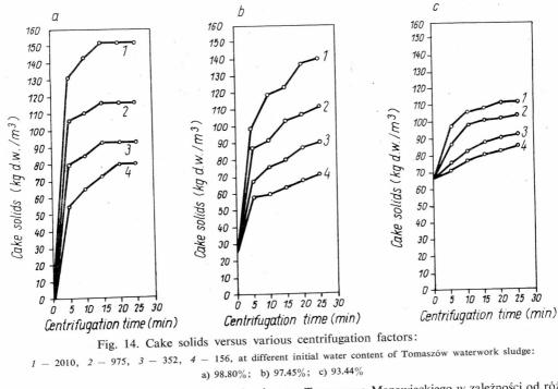
Rys. 14. Efekty odwadniania osadu pokoagulacyjnego z Tomaszowa Mazowieckiego w zależności od róż-
