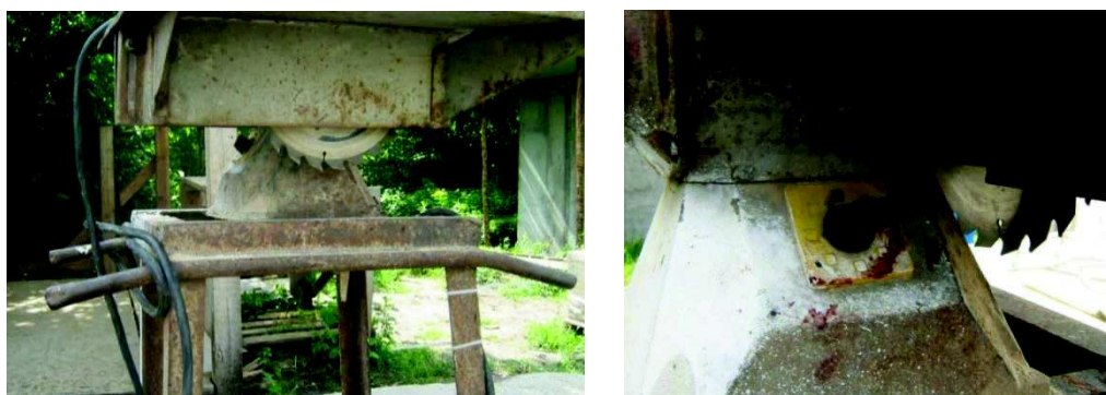
Rys. 6.17 Nieprawidłowy stan techniczny piły tarczowej (Protokół Kontroli: 16305-5303-K050-Pt/14)
