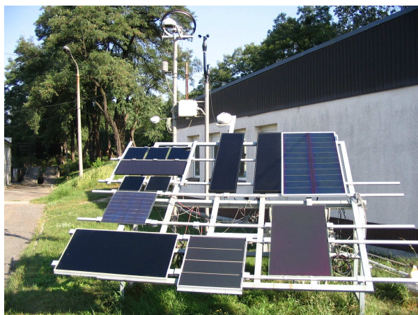
Rys. 4.4.2. Stanowisko badawcze: a) moduły fotowoltaiczne na stelażu, b) stacja meteorologiczna
