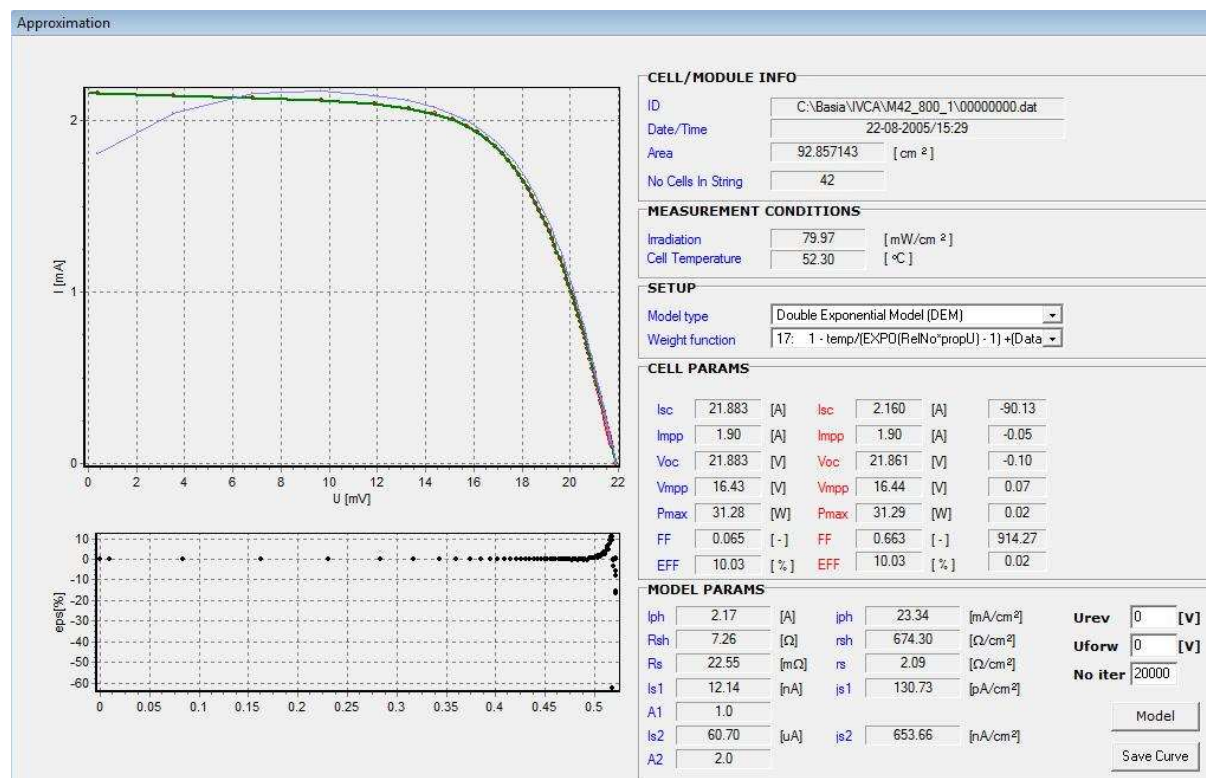
Rys. 4.5.1. Wygląd monitora komputerowego przy obsłudze programu do aproksymacji krzywych prądowo-napięciowych modułów fotowoltaicznych. Poszczególnymi kolorami oznaczono krzywe czerwona – wyniki pomiaru w warunkach naturalnych, zielona – krzywa zaaproksymowana, niebieska – funkcja wagi
