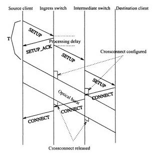
Fig. 1. JET signaling protocol.
