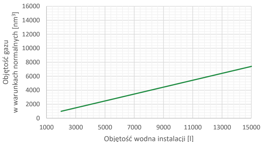
Rysunek 37. Zależność objętości gazu w warunkach normalnych od objętości wodnej instalacji przy ciśnieniu składowania 200 bar
