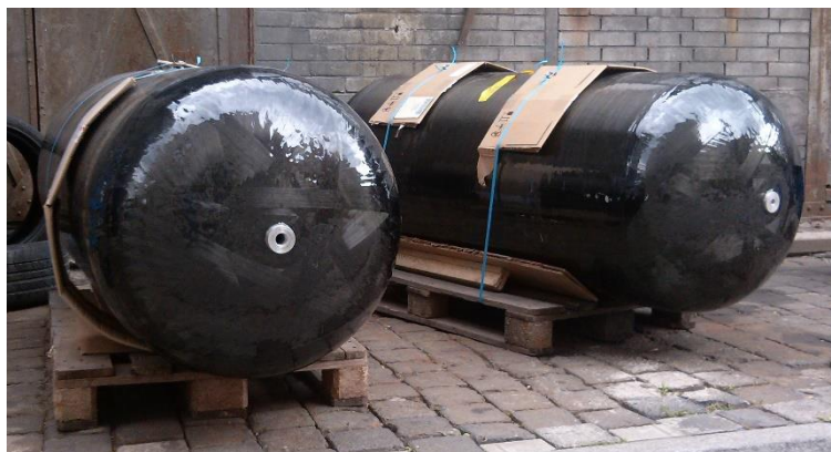
Rysunek 19: Wysokociśnieniowe zbiorniki kompozytowe firmy Seifert and Skinner – Belgia (ciśnienie 300 bar, objętość w. 700 l, masa: 90 kg)
