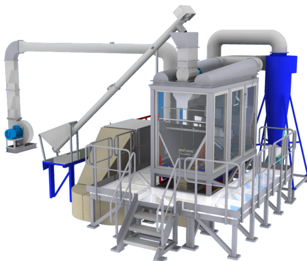
Rys. 4: Schemat suszarni fluidyzacyjnej
