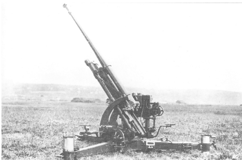
75 mm armata pl. F-Y SCHNEIDER nr 4 (wz. 35) – położenie bojowe
