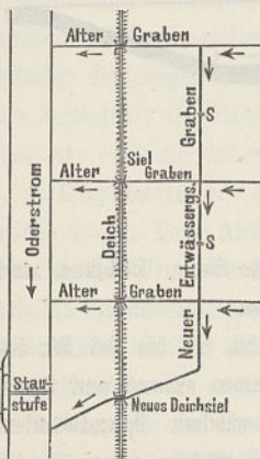
Abb. 18. Anordnung eines Entwässerungsgrabens.
