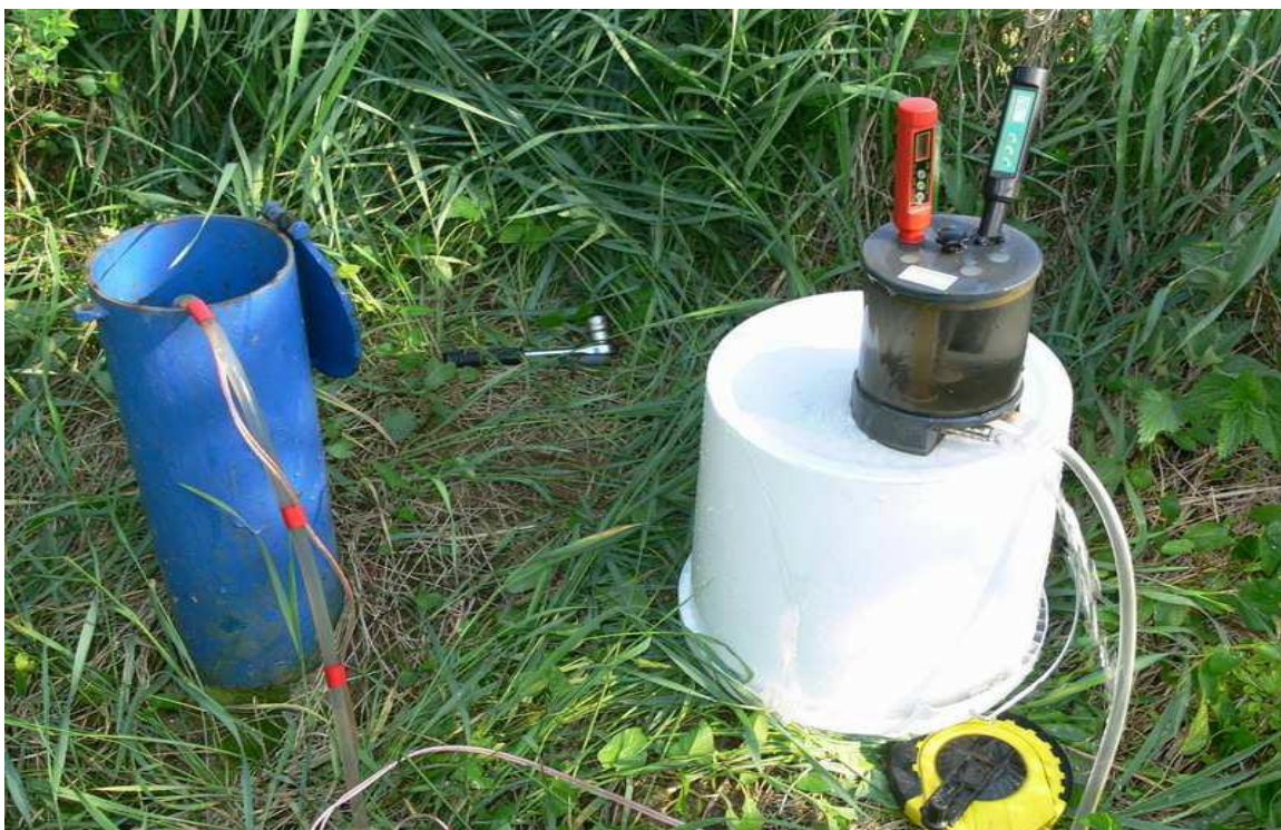
Rys. 35. Przepompowanie wód podziemnych z piezometru. [ źródło; Eko-projekt)
