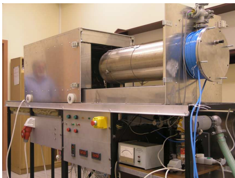
Rys. 3.1. Komora reakcyjna do wytwarzania nanocząstek srebra w podwyższonej temperaturze w atmosferze beztlenowej (konstrukcja opracowana i wykonana w Zakładzie Technologii Aparatury Elektronicznej Politechniki Wrocławskiej)
