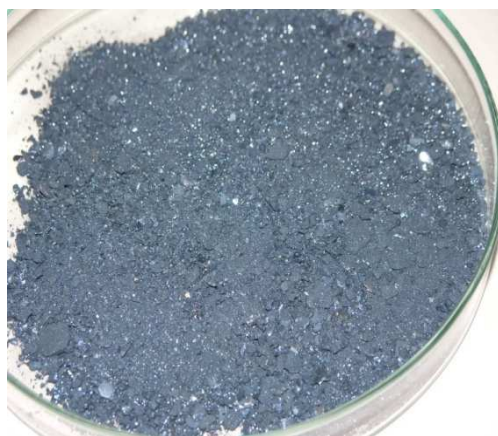
Rys. 3.2. Nanocząstki srebra w otoczce karboksylowej
