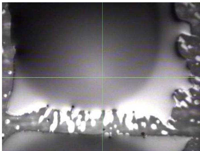
Rys. 3.10. Efekt rozptywania się krawędzi uzyskany po ogrzaniu kartridża z atramentem AX JP-6n do 60 °C [35]
