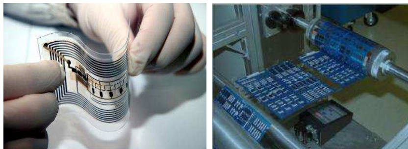
Rys. 2.15. Drukowany „z rolki” system RFID firmy Holst Centre [55]
