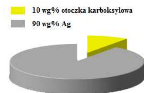
Rys. 3.5. Analiza ilościowa nanocząstek srebra z karboksylową otoczką ochronną
