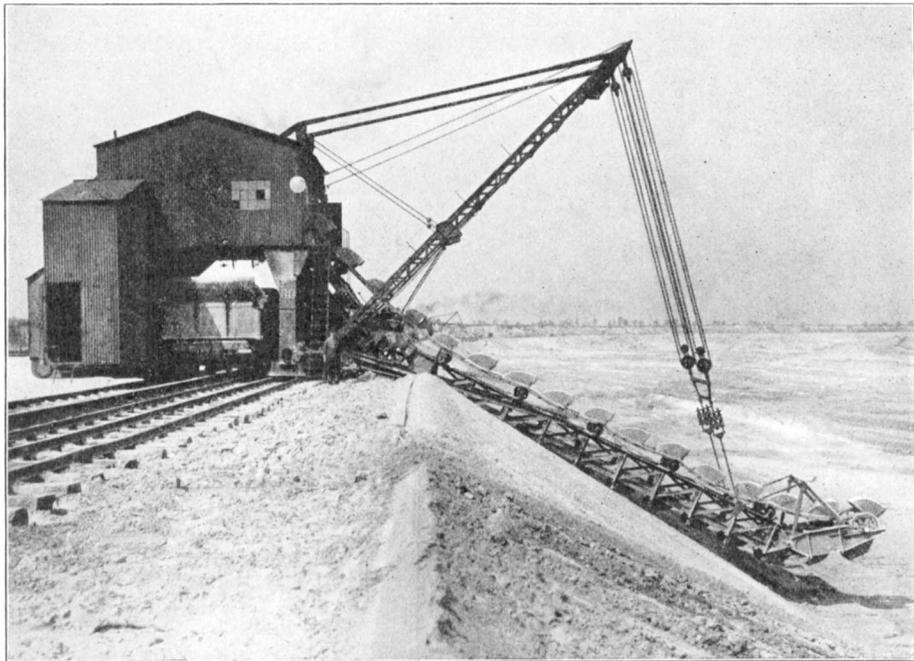
Abb. 7. Tiefbagger der Lübecker Maschinenbauanstalt für 200 cbm Stundenleistung.
