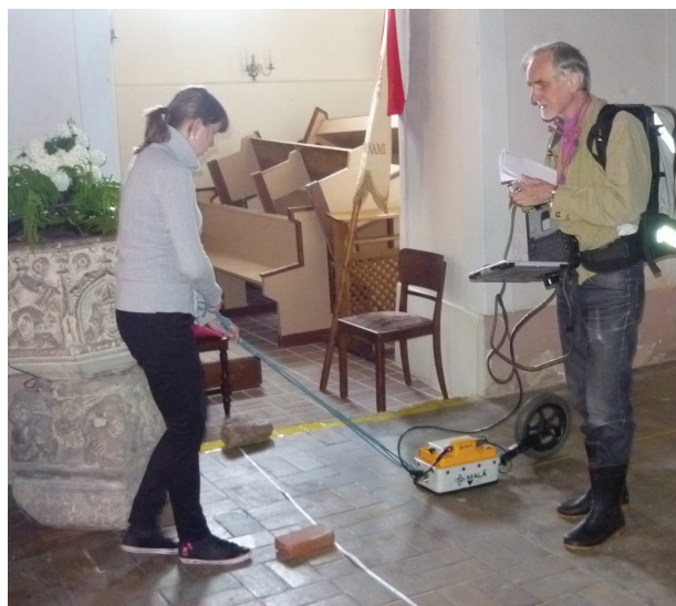
Il. 5. Radar do penetracji gruntu RAMAC/GPR, antena ekranowana 800 MHz
