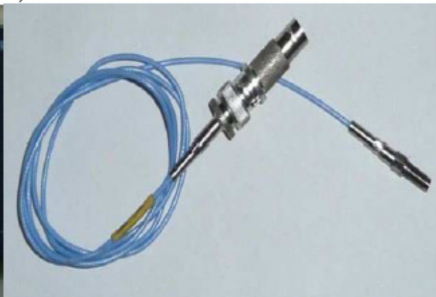
Rys.2.4.23 Zestaw do pomiaru ciśnienia wewnątrz cylindra: a)wzmacniacz ładunku AVL-6705 , b) czujnik GM12D
