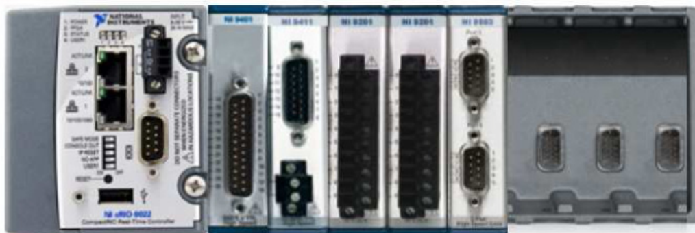
Rys. 2.5.1. Compact Rio (CRio) z kartami pomiarowymi i sterującymi
