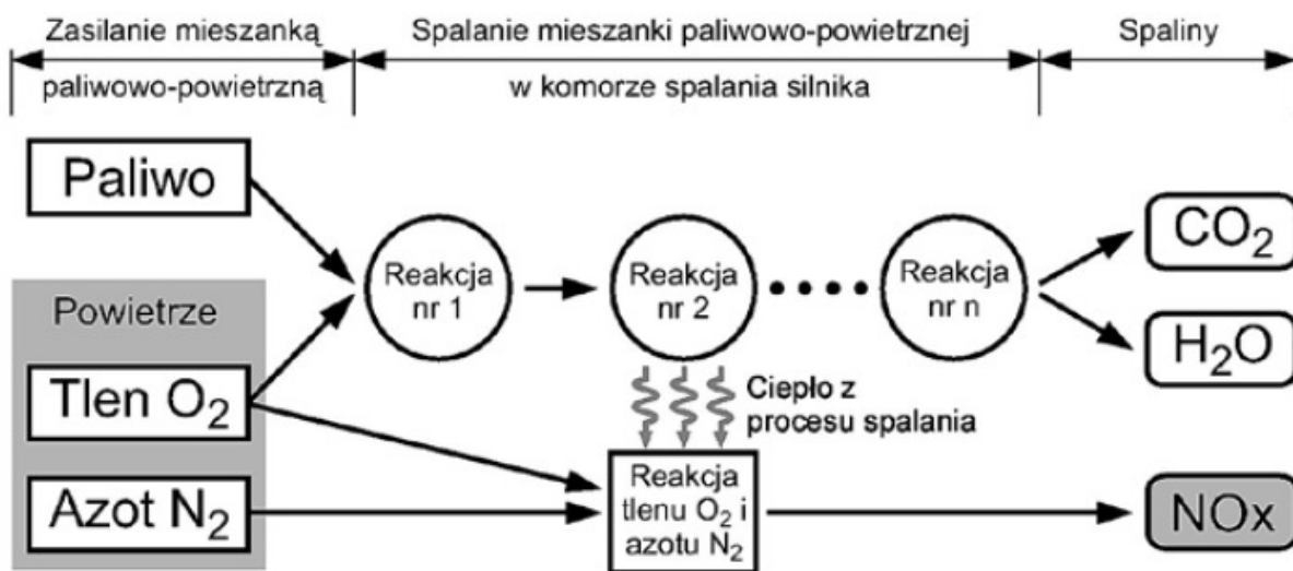
Rys. 2.2.1. Schemat blokowy tworzenia tlenków azotu w procesie spalania w silniku spalinowym według mechanizmu paliwowego [Mys10]
