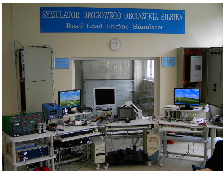
Rys. 2.4.1. Widok panelu sterującego hamownią silnikową - urządzenia i instrumenty badawcze
