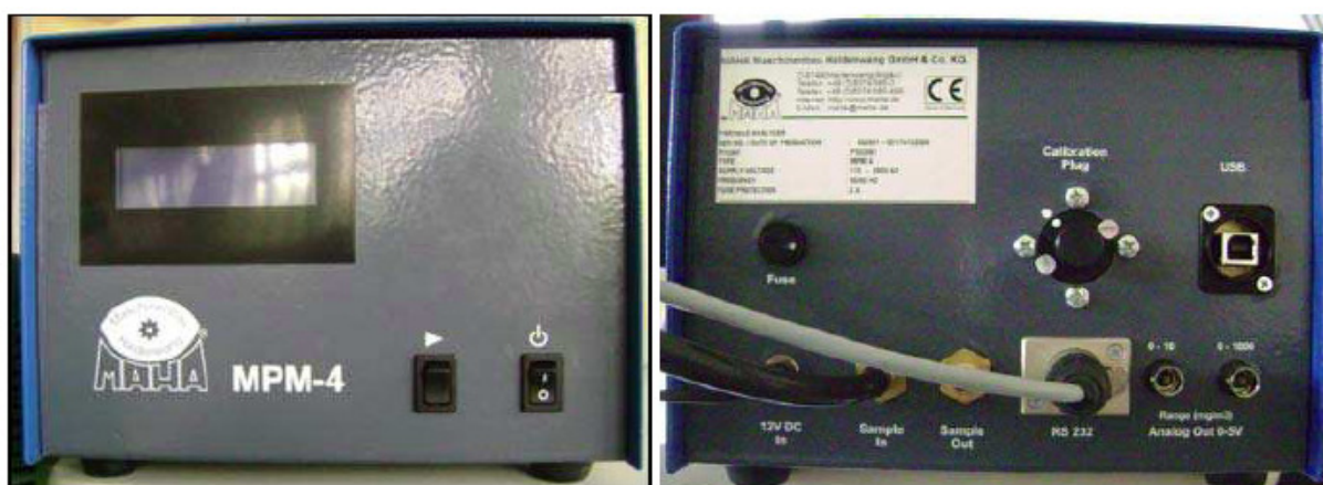
Rys. 2.4.21. Miernik cząstek stałych Maha MPM-4
