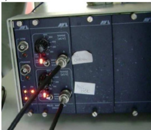
Rys.2.4.23 Zestaw do pomiaru ciśnienia wewnątrz cylindra: a)wzmacniacz ładunku AVL-6705 , b) czujnik GM12D
