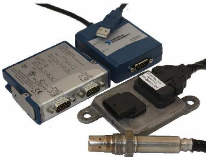
Rys. 2.4.28. Zestaw pomiarowy tlenków azotu \text{NO}_x oraz tlenu \text{O}_2 firmy DRIVEN [Dri13]
