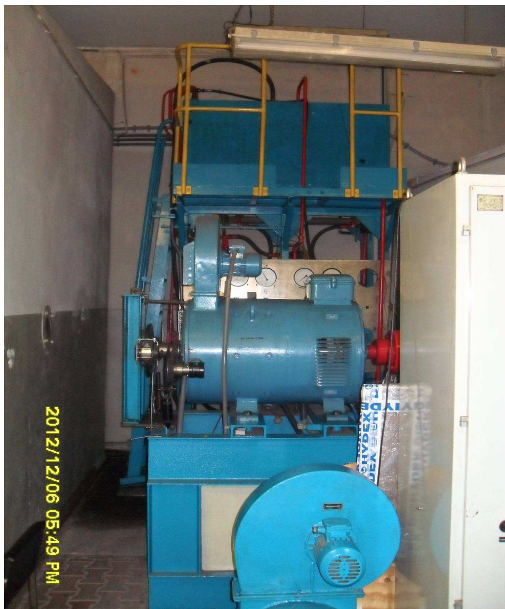
Rys. 6.4. Stanowisko badawcze: silnik napędowy prądu stałego, pompa zasilająca, silnik prądu zmiennego
