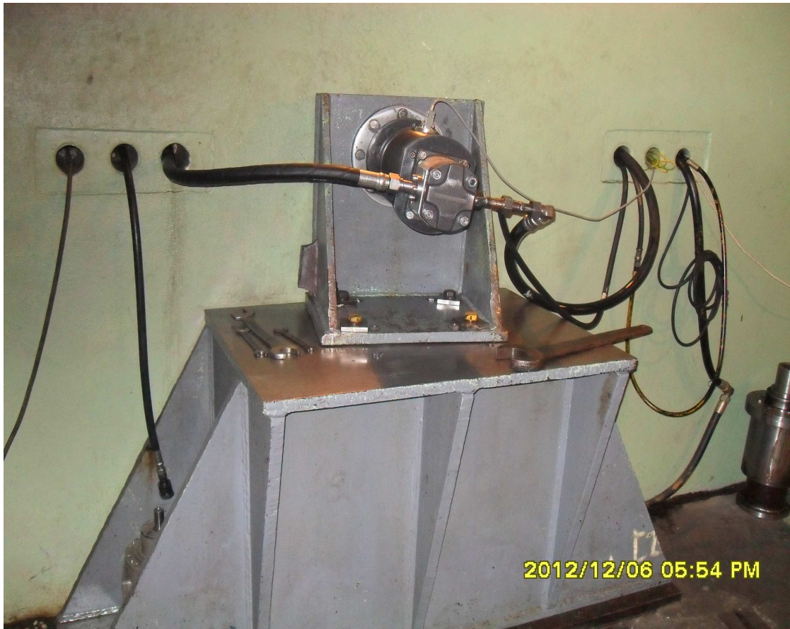
Rys. 6.7. Stanowisko badawcze: pompa zębata z podciętą stopą zęba w komorze kaustycznej
