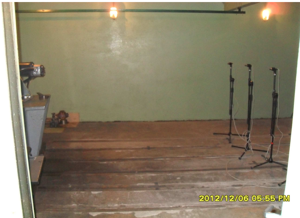
Rys. 6.8. Stanowisko badawcze: komora akustyczna
