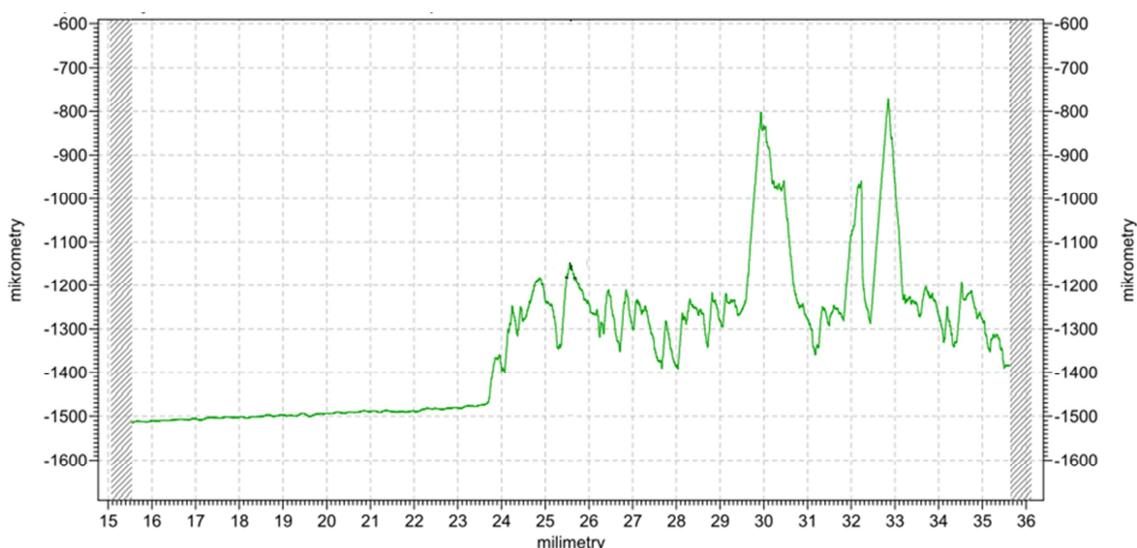
Rys. 88. Wyniki pomiaru wysokości zadzioru w profilu wzdłużnym wykonanego za pomocą profilografometru Form Talysurf 120L firmy Taylor Hobson, ( a_p = 0.75 mm, v_c = 180 m/min, f_o = 0.3 mm/obr).
