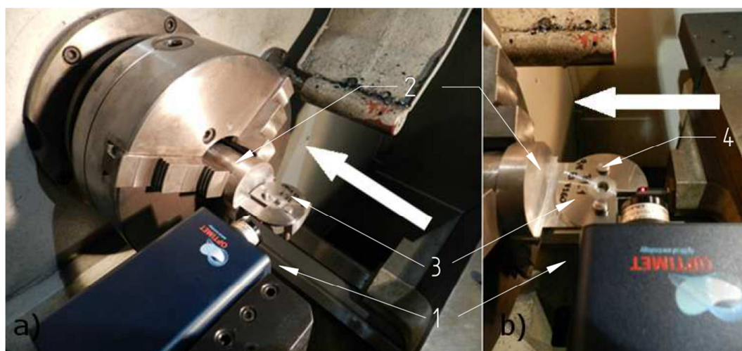
Rys. 117. Sposób pomiaru cech geometrycznych zadzioru z zaznaczonym kierunkiem ruchu czujnika: a) pomiar długości b oraz obniżenia c zadzioru, b) pomiar wysokości zadzioru a, 1 – czujnik, 2 – uchwyt specjalny, 3 – próbka, 4 – kołki ustalające.
