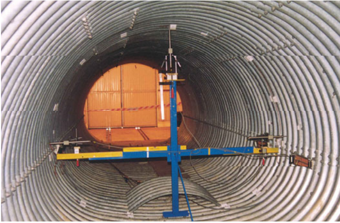
Rys. 3.18. Widok na stojak z czujnikami indukcyjnymi do pomiaru przemieszczeń.
