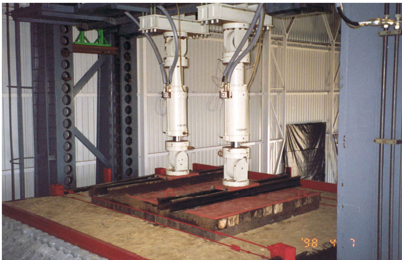
Rys. 3.9. Widok na siłowniki i płytę do przeniesienia obciążenia na grunt.
