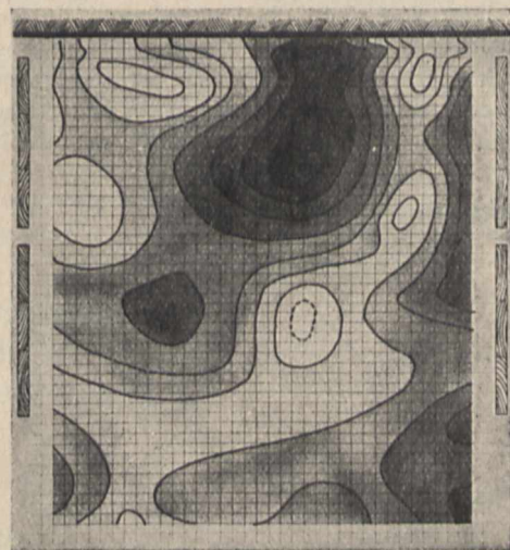
Bild 3. Schalldruckverteilung in der Horizontalebene einer Wandnische
