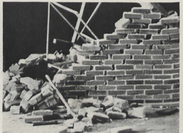
Bild 1 (links). Zerstörung je eines Modellhauses mit Mörtel- und Trockenmauerwerk durch Stoß auf die Giebelmauern
