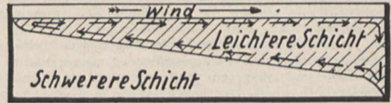
Bild 2. Vom Wind hervorgerufene Zirkulation in geschichtetem Wasser
