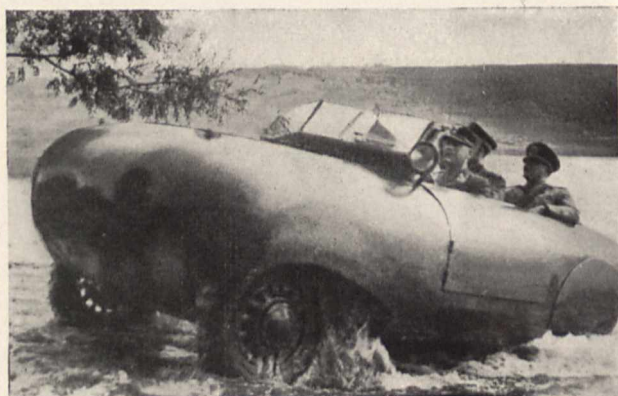
Bild 2. Dank der großen Bodenfreiheit und des Vierrad-antriebes erklimmt der Wagen mühelos die Uferböschung
