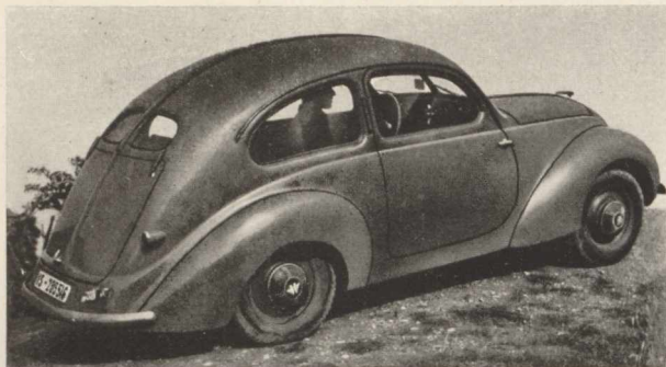
Bild 3. Der 1,3-Liter Hanomag in Stromform mit selbsttragender Karosserie
