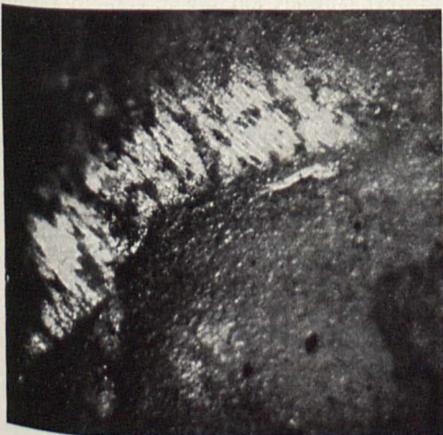
Bild 4a. Randbezirk der in Bild 5 gezeigten, mittels abgeschnittener Bohrdrüse im Experiment geätzten Mulde bei auffallendem Licht im Mikroskop betrachtet. — Vergrößerung 65fach (nach Ankel)
