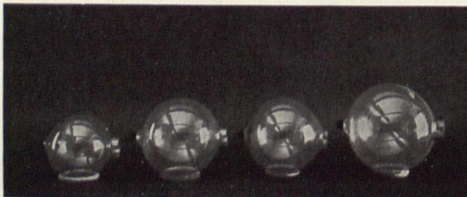
Bild 1. Original-Glaskugelresonatoren von Helmholtz. — Vorhanden im Deutschen Museum, München; ebenda photographiert
