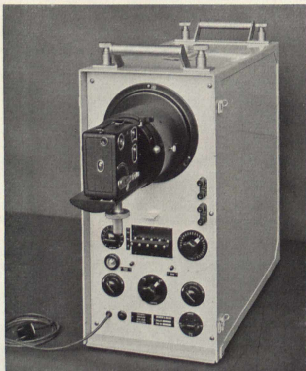
Bild 5. Gesamtansicht eines Tonfrequenz-Spektrometers mit aufgesetzter Schmalfilmkamera, wodurch die Anzeige der Braunschen Röhre dokumentarisch festgelegt wird
