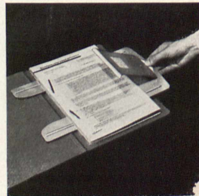
Bild 3. Zange zum Herausheben mehrerer Blätter aus einem Schnellhefter
