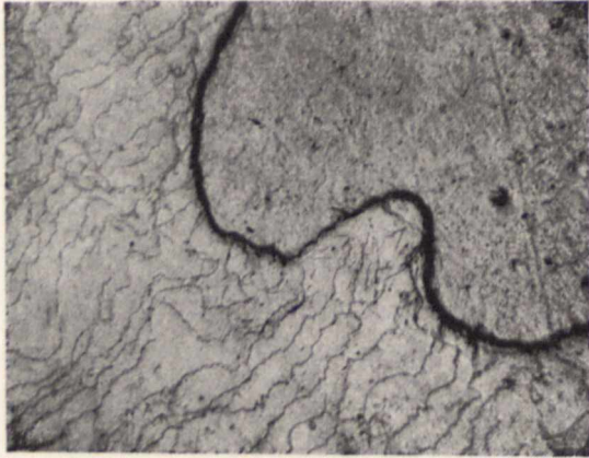
Bild 3. Teilweise lackierte Zuchtperle. Mikrophotographie der Oberfläche. Rechts oben lackierte Fläche
