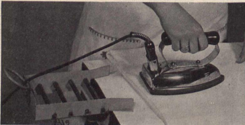
schohen. Sobald das Eisen die zweite Rolle passiert, kippt die Spitze des Bügeleisens hoch und hebt sich von der Bügeldecke weg. An dem Rost ist eine einfache Schnurregelung angebracht. Die Schnur läuft durch einen an der Rückwand des Rostes aufgesetzten Führungsring, und zwischen Rost und Wandstecker läuft in der Schnur ein einfacher Gewichtring, der die Schnur automatisch zurückzieht, so daß sie nicht mehr bei der Bügelarbeit hindert und nicht durch das Eisen beschädigt werden kann. J. U.
