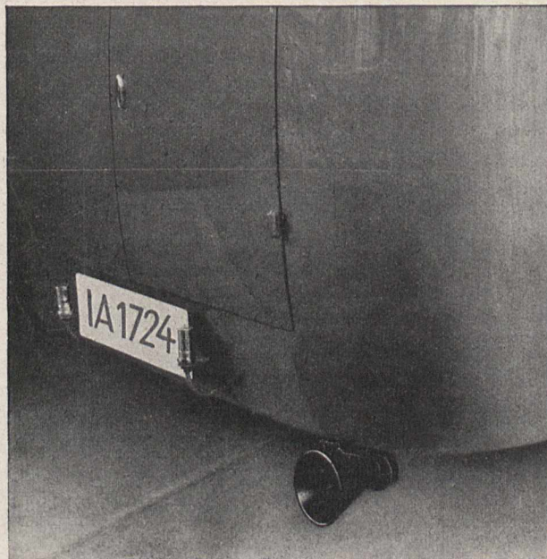
Bild 1. An der Rückseite des Wagens ist unten das in einem Trichter eingebaute Mikrophon angebracht, das die Zeichen überholender Kraftwagen auffängt. (Werkphoto)
